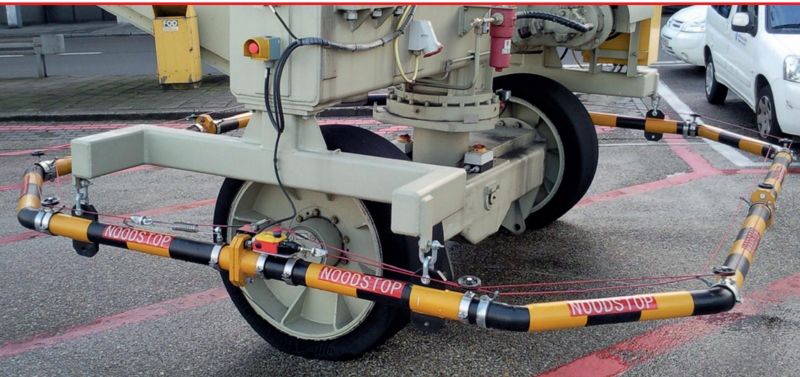
Der Sicherheits-Seilzugschalter SRM von BERNSTEIN kommt beispielsweise an Fluggastbrücken zum Einsatz. Fluggastbrücken ermöglichen das geschützte Ein- und Aussteigen an Flughäfen weltweit.
